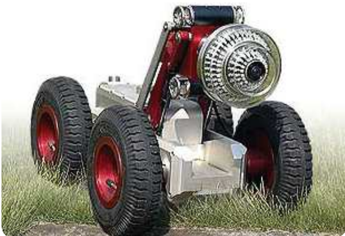
〈그림 1〉 핀란드 Painehuhtelu Oy PTV사의 Digisewer 시스템
